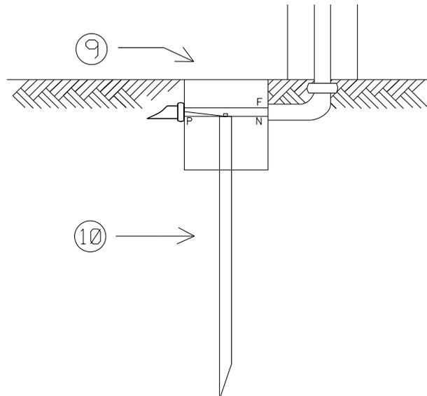
Detalhe 2: Instalação de aterramento na caixa de passagem
