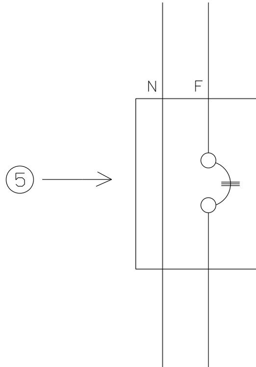
Detalhe 3: Diagrama Elétrico de conexão do disjuntor
