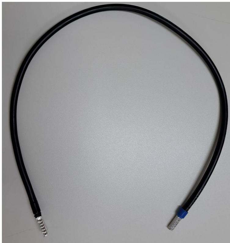
Figura 4 – Segmento fase do ramal de entrada que deverá ser disponibilizado pelo cliente: 50 cm de condutor 16mm<sup>2</sup> de cobre; uma extremidade com terminal sem isolamento; outra extremidade com terminal com isolamento
