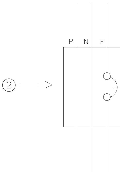
Detalhe 2 : Diagrama Elétrico de conexão do disjuntor
