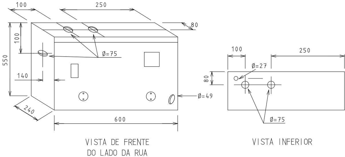
**DESENHO 42 - CAIXA TIPO CM-3LVP PARA MEDIÇÃO COM INSTALAÇÃO INDIRETA E PROTEÇÃO - MONOFÁSICA E POLIFÁSICA – DISJUNTOR COM ACESSO PELO INTERIOR DA PROPRIEDADE**
