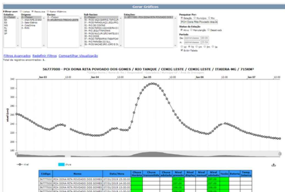
Figura 6 - Visualização do Hidro - Telemetria de dados em tempo real
