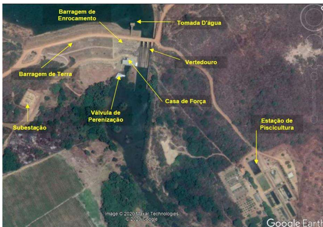
Figura 1 – Imagem aérea com a identificação das estruturas
