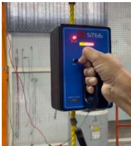
Figura 3 - Testador de cordas e bastões isolantes (Teste de integridade de corda isolante com equipamento da STEE).
