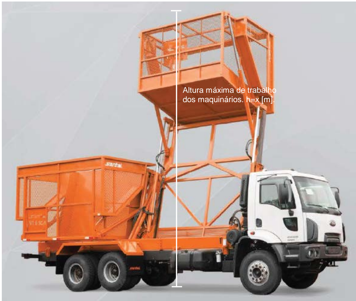
Figura 01 – Altura máxima de trabalho. Exemplo: Caminhão com cesta de transbordo.
